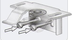
Dacă jaluzeaua se montează pe perete, folosiți aceeași pași ca la montajul pe tâmplărie, doar că aveți nevoie de dibruri\* și holșuruburi adecvate cu tipul de perete.
