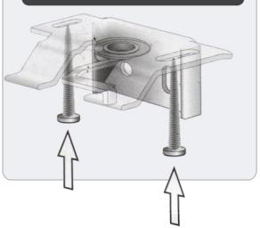
Dacă jaluzeaua se montează pe tavan sau în interiorul șpaletului, poziționați clema conform imaginii din stânga, înlocuiți holșuruburile cu unele adecvate cu tipul de tavan, și adăugați dibruri\*. Urmați pașii 2-5.
